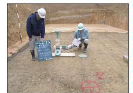
現場密度試験 (砂置換法)
